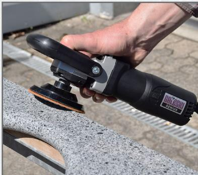
Besonders kompakte Einhandmaschine. (Abb. Genius 900 Vario/B mit Bügelhandgriff anstelle Seitenhandgriff)
