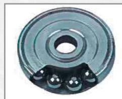
Der Autobalancer besteht aus Öl gelagerten Stahlkugeln, die sich auf einer Bahn um die Antriebswelle in einem Kugellager ähnlichem Gehäuse frei bewegen können und damit Unwuchten perfekt ausgleichen.
