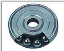
Der Autobalancer besteht aus Öl gelagerten Stahlkugeln, die sich auf einer Bahn um die Antriebswelle in einem Kugellager ähnlichem Gehäuse frei bewegen können und damit Unwuchten perfekt ausgleichen.
